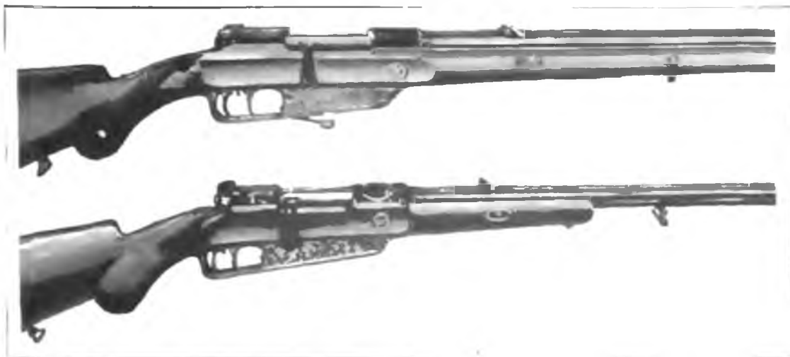
Abb. 55. Meppeler-Büchse für Mantelgeladn und Blattchenpulver. die untere mit reicher Verzierung.
