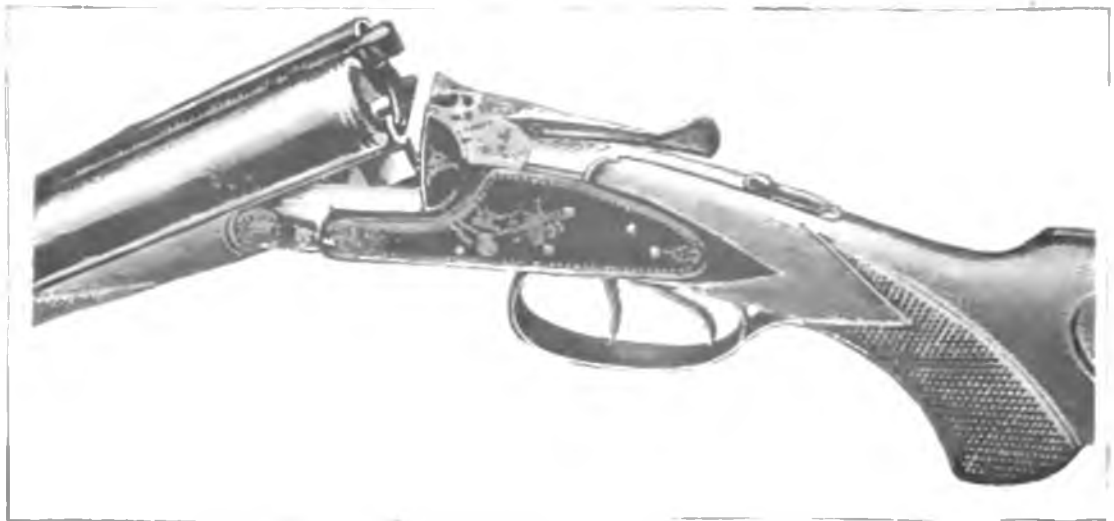
Abb. 46. Centralfeuer-Buchflinte ohne Magazine. Selbstpanner-System.
